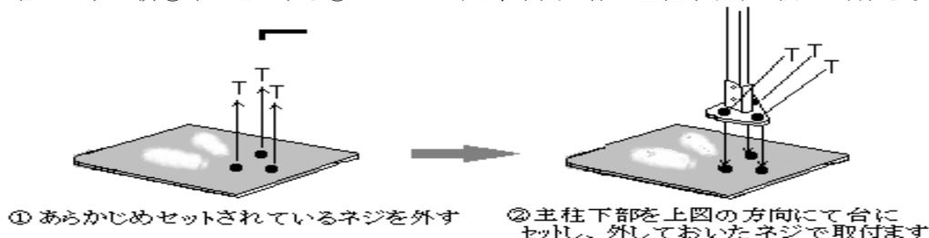
2. 主柱下段#3に主柱中段#2を右図の様に挿し込み、取付け、④主柱三段取付ネジ M3にて仮止めします
